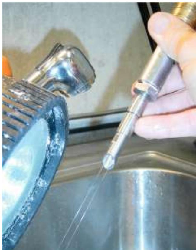
8. Убедитесь в нормальной работе отсечки перед установкой ее на бумагоделательную машину - подсоедините отсечку к обычному водопроводному крану гибким шлангом и наблюдайте за струей в свете стробоскопа, настроенного на частоту приблизительно 50 вспышек в секунду.
