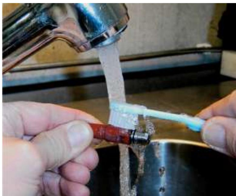
2. Для наружной очистки отсечек используйте маленькую щетку и воду. Вы можете также использовать кислотные или щелочные очищающие составы для удаления волокон и частиц наполнителя, но не рекомендуется подвергать отсечки действию этих составов длительное время. Соблюдайте осторожность при использовании кислотных или щелочных составов!
