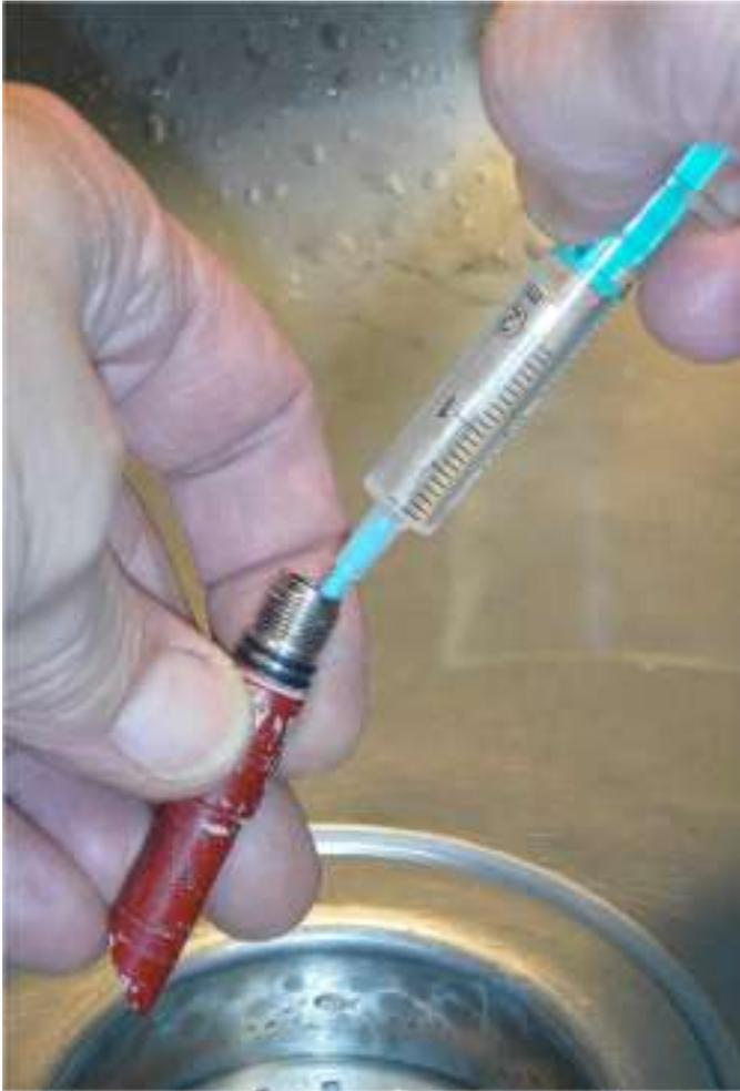
3. Если внутри отсечки заметны загрязнения, капните внутрь несколько капель соляной кислоты (HCl) при помощи пластмассового шприца, оставьте на несколько минут, чтобы кислота подействовала, а затем тщательно промойте отсечку водой.
